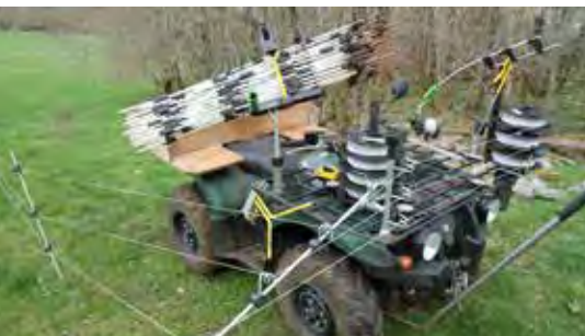
Pose et dépose de la clôture « spider » au quad © Xavier Rouhouse
